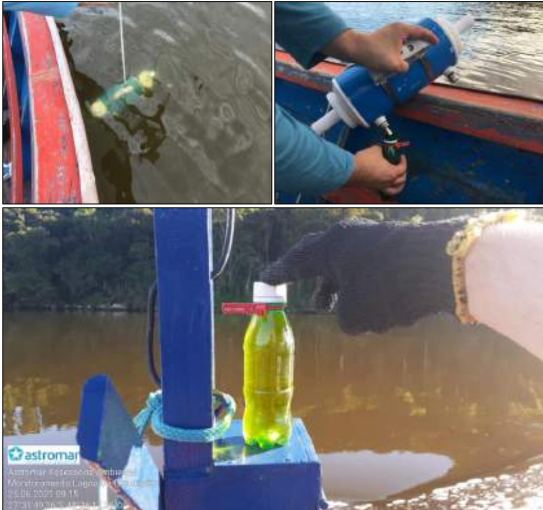
Figura 5. Procedimentos de coleta do fitoplâncton. Lançamento da garrafa de Van-Dorn para coleta de água. Transferência da amostra para garrafa Ambar. Amostra de fitoplâncton coletada.
