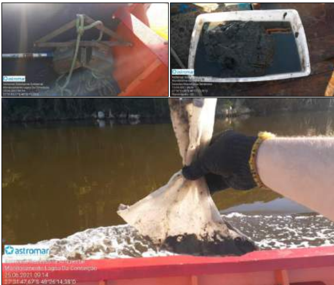
Figura 7. Procedimentos de coleta da macrofauna bentônica. Draga Van-Veen utilizada para coleta de sedimento. Amostra de sedimento na bandeja. Amostra de macrofauna bentônica coletada.
