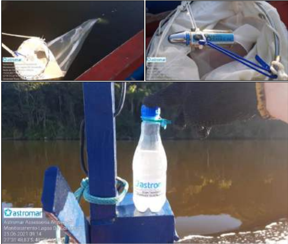
Figura 6. Procedimentos de coleta do zooplâncton. Lançamento da rede de plâncton para coleta de água. Detalhe do fluxômetro. Amostra de zooplâncton coletada.
