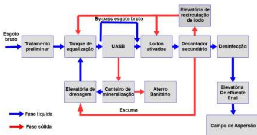
Figura 64: Fluxograma ETE Barra da Lagoa
