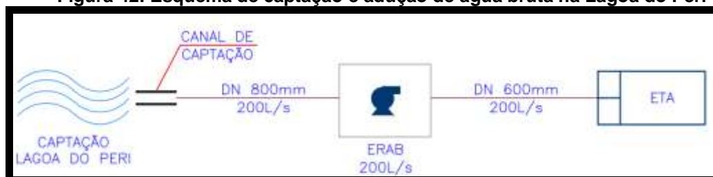
Figura 42: Esquema de captação e adução de água bruta na Lagoa do Peri
